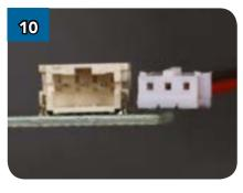
Выступ на верхней части вилки должен совпасть с углублением в разъёме.
