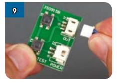
Вставьте в разъём платы, помеченный знаком OUT, вилку проводов, подключённых к индикатору.
