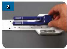
Выровняйте деталь (LPR-07) с центральной частью опоры R2-D2, обращая внимание на шесть небольших монтажных отверстий в пластине (LPR-09).
